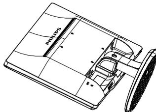
2. 按锁定夹，从底座支撑柱上卸下底座支撑臂。
