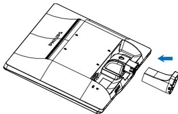
3. 用双手拿住显示器底座支撑臂，用力将底座支撑臂插入底座支撑柱。
