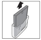
5 将复合高效去甲醛滤网放回净化器 内部。
