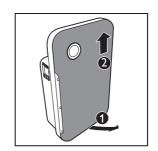
**3** 要卸下预过滤网,请抓住两个凸缘,然后朝您自己的方向拉动过滤网。
