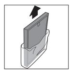
**7** 将复合高效去甲醛滤网放回净化器 内部。
