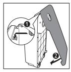
10 重置复合高效去甲醛滤网使用寿命 (请参阅"重置过滤网使用寿命计 数器")。
