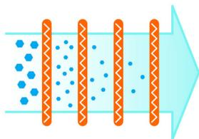
过滤系统包含四个独立的隔层。这可确保所有尘埃均被捕捉到吸尘器中。
