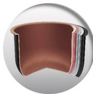
双重特色内锅，精心为您打造“柴灶”美味。超厚 2.0 毫米内锅，导热更均匀。行业领先五层金色内锅，细微之处体现巧思、精工。1. 水晶高硬度涂层：高硬度耐磨易洗；2. 金色聚热底层：充分积聚热能，大大提高内锅加热效果；3. 超厚高效导热合金胆：导热均匀；4. 树脂保护膜：令合金胆更坚固耐用；5. 炫黑防刮隔热涂层：蓄能保温，将热量长久锁定。
