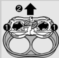
**3** 向中间捏中央弹簧的两个边 (1)，并向上提起取出固定架，将其从剃须刀头部件中取出 (2)。
