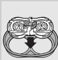
**6** 将固定架重新安装到剃须刀头部件上。
