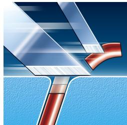
飞利浦剃须刀的双层刀片系统：第一层刀片先将胡须提起，再由第二层刀片将其剃去，使剃须更贴面更舒适。
