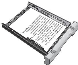
3. 使用手动进纸槽手动双面打印：将打印纸张正面朝下、页头朝前（朝向设备）放入手动进纸槽。
