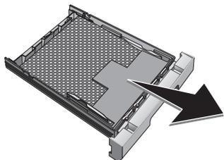
2. 根据打印纸张调整纸盘长度。按下纸盘上的锁定键。滑动后板直到卡入合适的标记: Legal = LG, A4 = A4, A5 = A5, Letter = LE B5 = B5。
