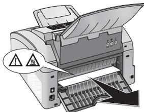
4. 关闭卡纸翻盖 关闭卡纸翻盖时定影器锁紧杆将自动收到初始位置。
