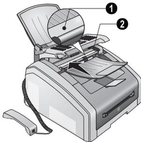
3. 使用柔软的无绒布清洁文件进纸器的橡胶滚轴（6x）。转动进纸轮子，整个轮子都必须都要清洁。
