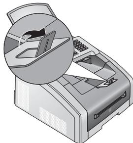
3. 在 A5 纸张上打印：再次将出纸槽支架和拉出的纸张阻止器向后折起。
