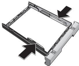
6. 将进纸托盘推入至设备中, 直至止点。
