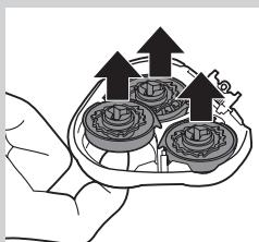
**5** Holicí hlavy čistěte vždy po jedné. Každá holicí hlava se skládá z nožového věnce a holící korunky.
