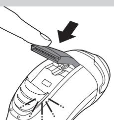
**3** Nakon podrezivanja, zatvorite trimer i isključite aparat za brijanje.
