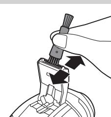
**3** Почистити тример можна за допомогою щіточки для чищення, використовуючи сторону з короткою щетиною. Проводьте щіточкою вгору-вниз вздовж зубців тримера.
