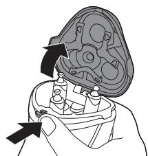
**5** Otočte pojistku směrem doleva (A) a vyjměte zajišťovací rámeček (B).
