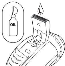
*Tip: Aby byl zajištěn optimální výkon při zastřihování, kápněte na zuby zastřihovače jednou za šest měsíců kapku oleje na šicí stroje.*
