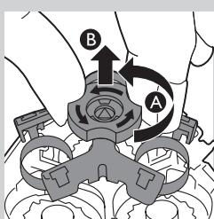
**5** Odkręć blokadę w lewo (A) i wyjmij element zabezpieczający (B).
