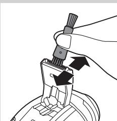
**3** Почистете машинката за подстригване, като използвате края с къси косми на четката за почистване. Четкайте нагоре и надолу успоредно на зъбите на машинката.
