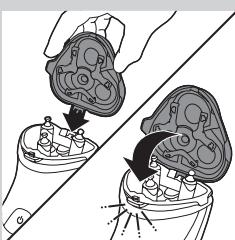
**8** Ievietojiet jaunā skūšanas bloka izcilni spraugā skuvekļa augšpusē. Pēc tam aizveriet skūšanas bloku.
