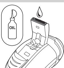
Sugestie: Pentru a garanta performanțe optime de tundere, ungeți dinții dispozitivului de tundere cu puțin ulei pentru mașina de cusut o dată la șase luni.
