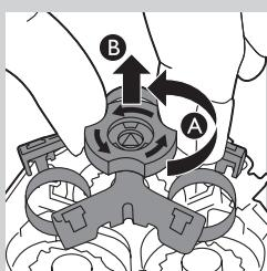
**4** Odkręć blokadę w lewo (A) i wyjmij element zabezpieczający (B).
