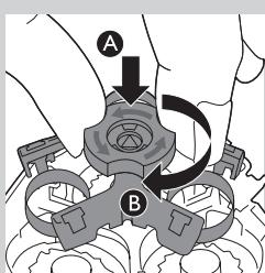
**7** Następnie załóż element zabezpieczający na moduł golący (A) i obróć blokadą (B) w prawo.
