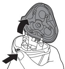
**5** Zámkom otočte proti smeru pohybu hodinových ručičiek (A) a vyberte prítlachný rám (B).
