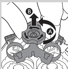
**4** Zámkom otočte proti smeru pohybu hodinových ručičiek (A) a vyberte prítlačný rám (B).
