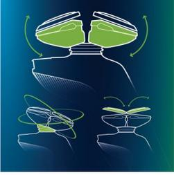
此款剃须刀的 3D 智能贴合轮廓跟踪剃须刀头可根据您的面部曲线无缝调节，从而减少对皮肤的刺激。
