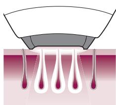
Prin intermediu tehnologiei pe bază de IPL sunt aplicate pe piele impulsuri de lumină delicate, absorbite de rădăcina firului de păr. Cu cât este mai închisă culoarea părului, cu atât mai multă lumină poate fi absorbită.
