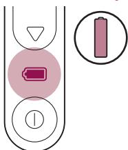
Când bateriile sunt complet încărcate, LED-ul de încărcare luminează verde continuu. Bateriile complet încărcate furnizează cel puțin 370 de pulsații la nivelul 5 de intensitate a luminii.
