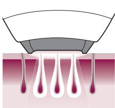
Technologie IPL aplikuje na pokožku jemné světelné impulzy, které jsou pohlcovány kořínky chloupků. Čím jsou chloupky tmavší, tím lépe vstřebávají světelné impulzy.
